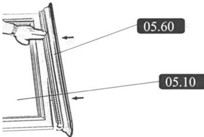
Установить карниз 05.60 на зеркало 05.10 и зафиксировать евровинтами при помощи отвертки. На евровинты установить заглушки.
