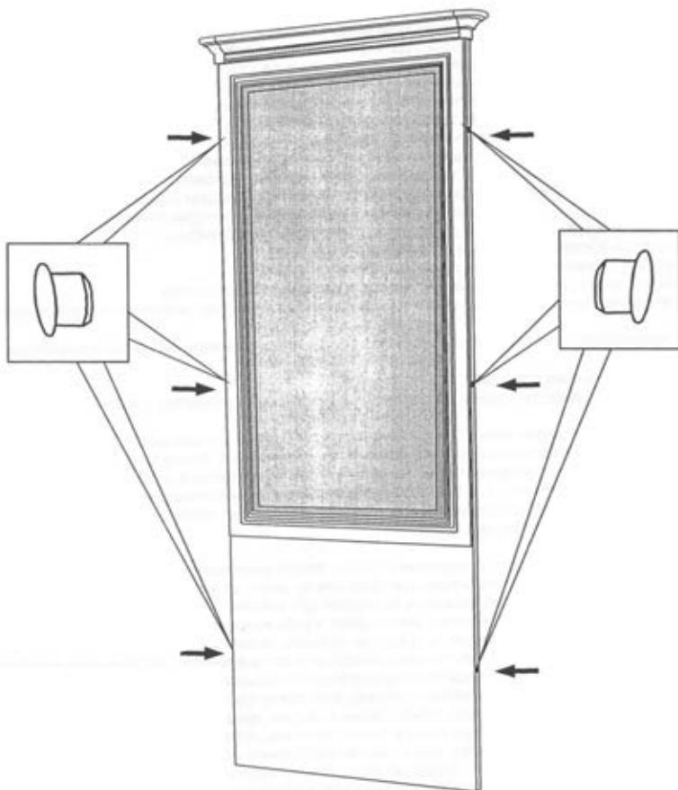
По окончании сборки изделия необходимо установить заглушки D=6мм в отверстия (предназначены для установки одно-дверного и трех-дверного шкафов и вешалки навесной) на боковых кромках.
