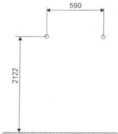
**Поставляемые в комплекте элементы крепления предназначены для фиксации изделия к кирпичным, каменным, железобетонным, деревянным стенам. Для стен других конструкций (ГВЛ и т.д.) элементы крепления изготовителем не поставляются. Для крепления изделия к стенам других конструкций (ГВЛ и т.д.) использовать крепеж, обеспечивающий надежное крепление изделия к данным стенам.**
